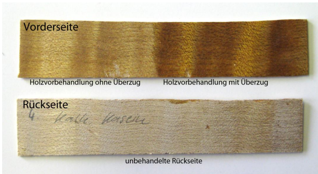
Abbildung B-6: Beispiel einer Probetafel zur Untersuchung der Holzvorbehandlung von Streichinstrumenten (#4). Vorderseite mit Holzimprägnierung zur Hälfte mit einem Öllack versehen (oben); unbehandelte Rückseite (unten).
