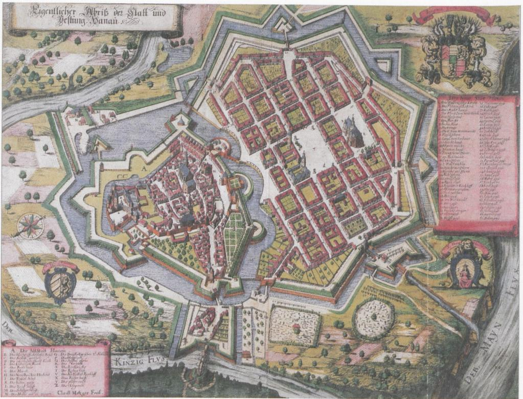
**Abb. 5: Tenailierte Festung Hanau.** Die Bollwerke bestehen aus einfach gewinkelten Wällen ohne Flanken oder eingezogene Kanonenhöfe. Die Flankierung erfolgt direkt von den Facen und von den vorgelagerten Ravelins bzw. dem Hornwerk zur Sicherung der Torpassage. (August Rumpf, *Eigentlicher Abriss der Stadt und Vestung Hanau*, 1684)
