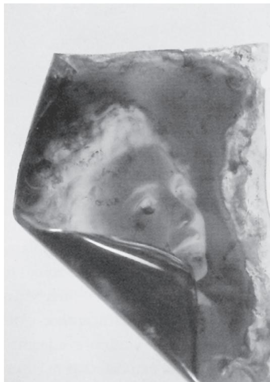
Abb. 4: Zersetzung eines Nitratfilmes, Deformierung des Trägers; aus: B. Lavédrine (u. a.): A Guide to the Preventive Conservation of Photograph Collections, S. 20.
