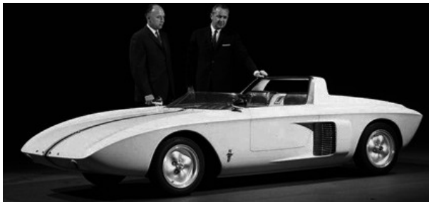
Abbildung 464: Eugene Bordinat/Philip T. Clark - Ford Mustang I – mit V4-Triebwerk u. Aluminium Body – Concept Car 1962
