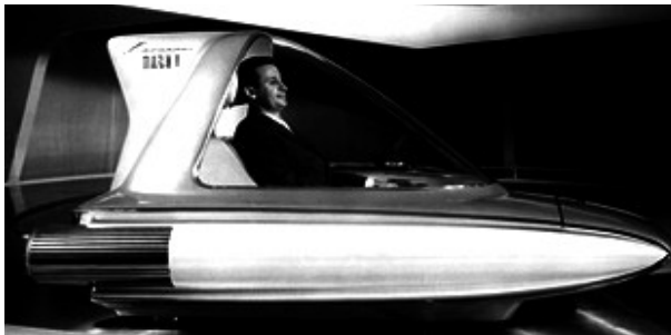
Abbildung 264: Ford Levacar Mach I (one man flying car – 350 km/h – powered by Air Jets) Prototyp 1959 – mit ungelöster Bremsfrage
