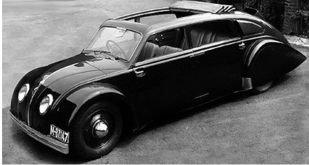
Abbildung 51: Tatra T 77 – mit luftgekühltem V8-Heckmotor 1934 – formal entsprechend Mercedes-Benz 150 W30 1934
