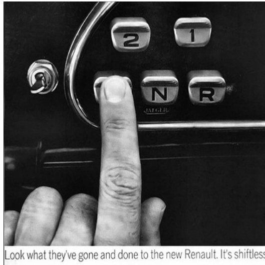
Abbildung 113: Renault Dauphine - Pushbutton Transmission ab 1955
