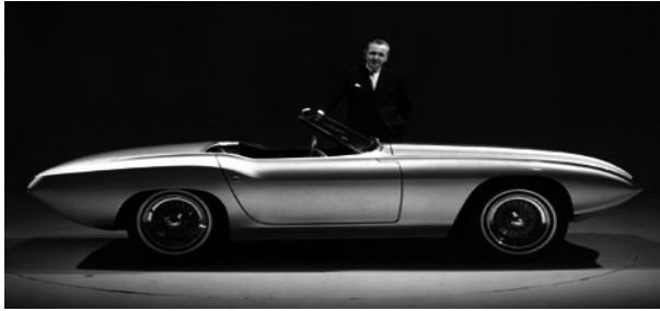
Abbildung 270: Eugene Bordinat - Ford Cobra – mit Royalex Lexan Body, Zippered Vinyl Top u. Hidden Headlamps 1963 – formal gleichartig Larry Shinoda – Chevrolet Corvette (GM) C2 – mit Plastic Body 1962
