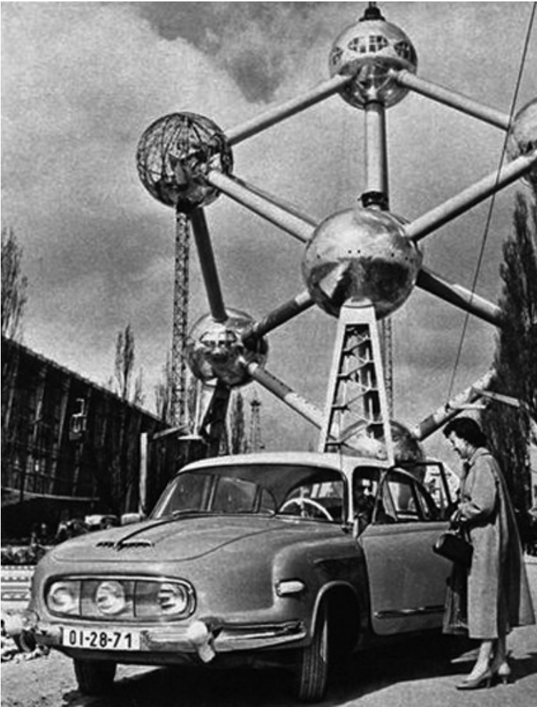
Abbildung 116: Tatra 603 Typ 1 – Bruxelles/Brussel Expo 1958 – mit luftgekühltem V8-Motor im Heck um 1956 – formal entsprechend Hudson Super Wasp Hollywood 1952
