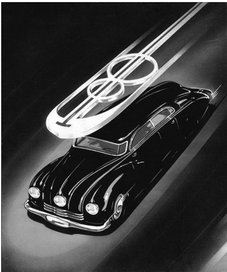
Abbildung 64: Tatra 87 – mit luftgeköhltem V8-Heckmotor um 1947
