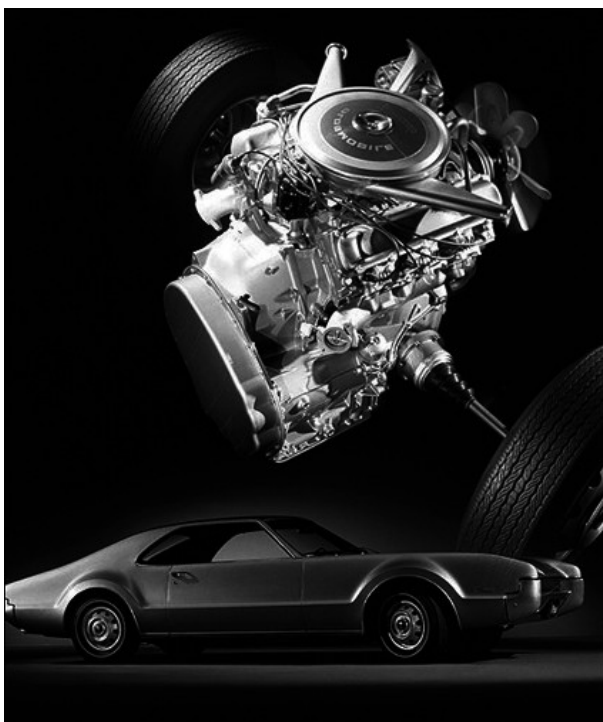
Abbildung 538: Oldsmobile (GM) Toronado – im Hexagon-Design – mit Rocket V8-Frontantrieb 1966
