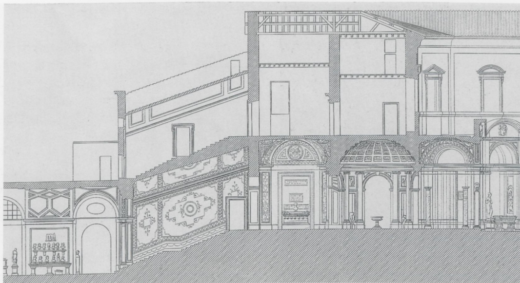
Fig. 43 Paul Letarouilly, Sezione delle scale sangallesche tra il giardino superiore e il Belvedere, dettaglio (Le Vatican, tav. 246), metà superiore
