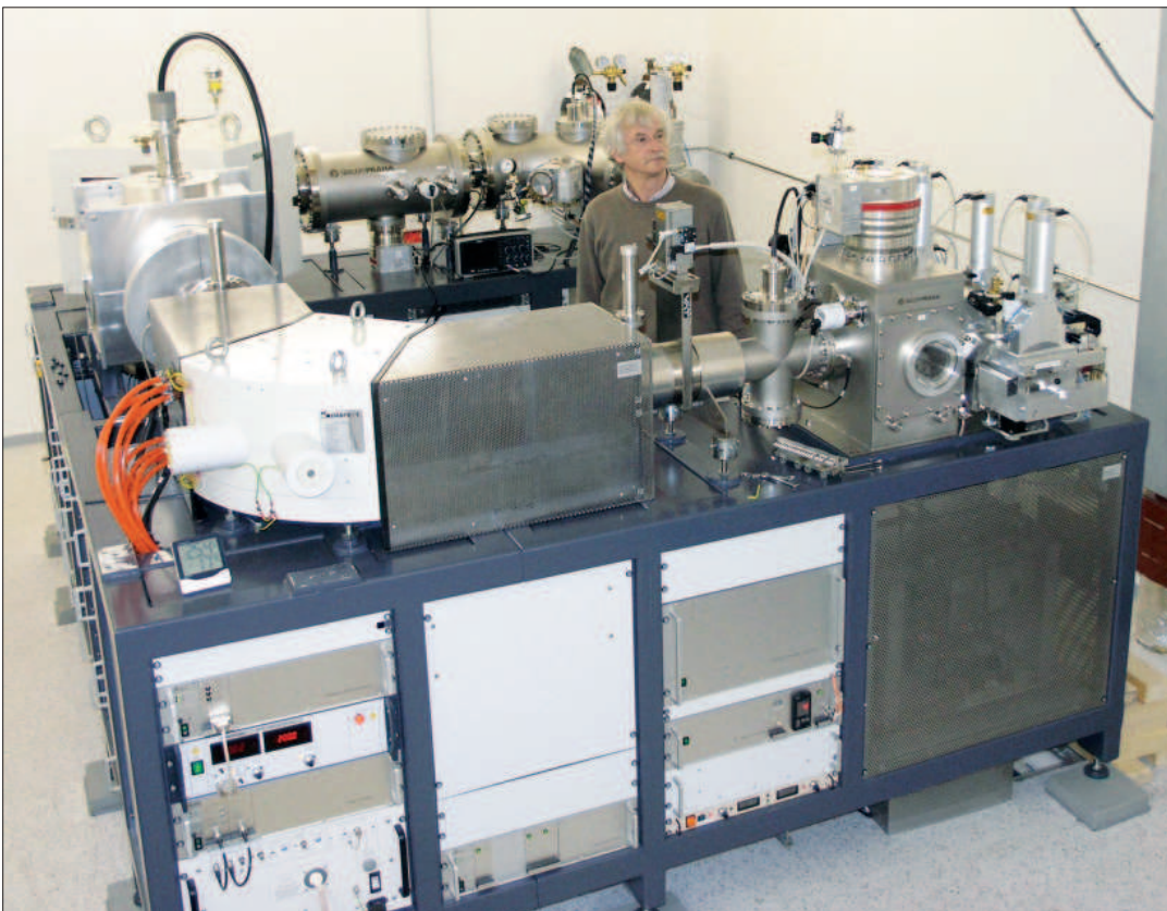
Abb. 4 Das MICADAS (Mini Carbon Dating System) Beschleunigermassenspektrometer des Klaus-Tschira-Archäometrie-Zentrums, bedient von dessen Leiter, Dr. Bernd Kromer. Foto: ?
