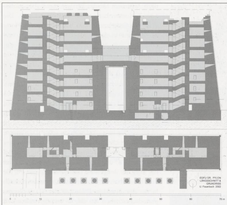
1. Pylon Längsschnitt und Grundriss, nicht verformungsgerechtes Aufmaß
