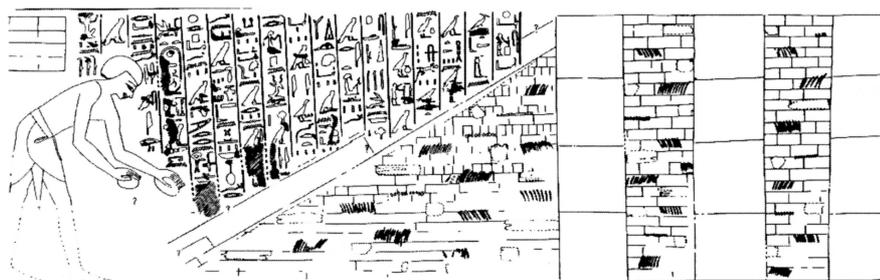
Abb. 5 Umzeichnung einer Ziegelbaurampe aus dem Grab des Rehmire (18. Dynastie)
