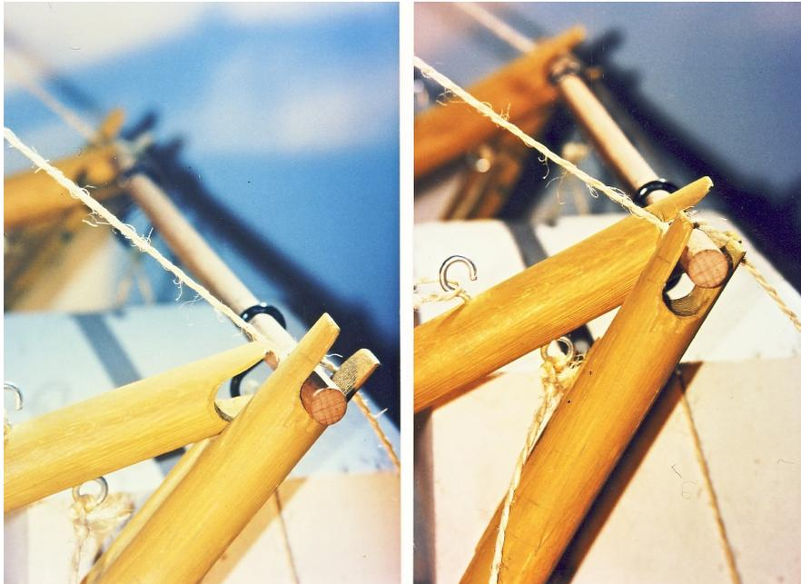
Abb. 7.5.7.2 Übernahme von Lasten in der Hebezeugkette nach Munt
