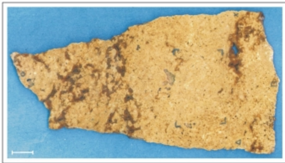
Abbildung 7. 4 Bad Langensalza, Probe Ls3; Probe mit makroskopisch sichtbaren roten Porenzementüberzügen in Poren Hohlräumen. Balkenlänge 1 cm.
