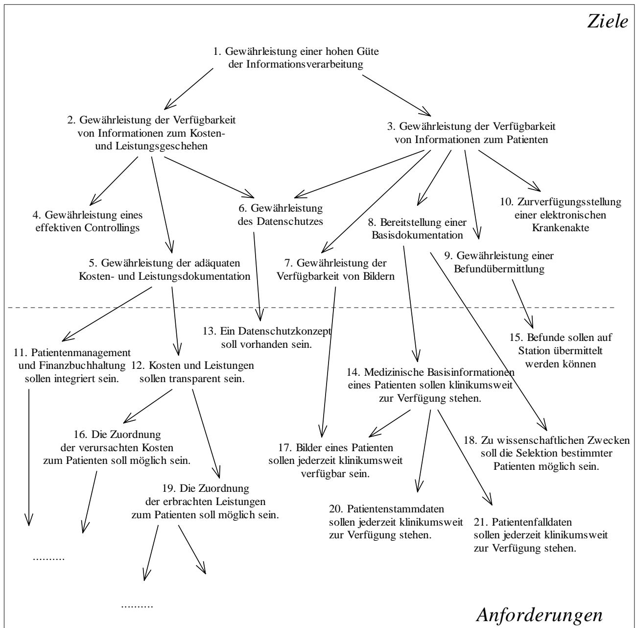
Abbildung 3-5: Beispiel für einen Graphen eines polyhierarchischen Anforderungsmodells (2).
