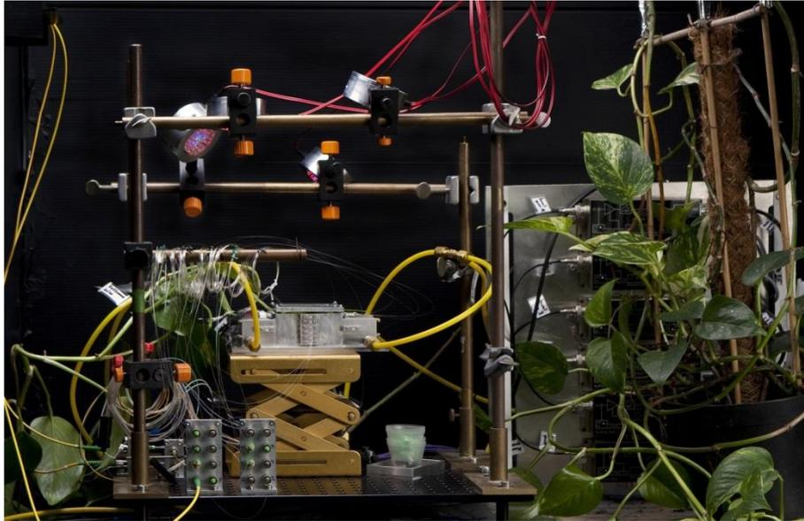
**Abbildung 4.1:** Foto des experimentellen Aufbaus. Im Zentrum die Blattmesskammer mit darauf fixiertem Blatt. Oben im Bild die LED-Beleuchtung, rechts die Messpflanze und Stromverstärker, im Vordergrund die Glasfaser-Kopplungsbuchsen.
