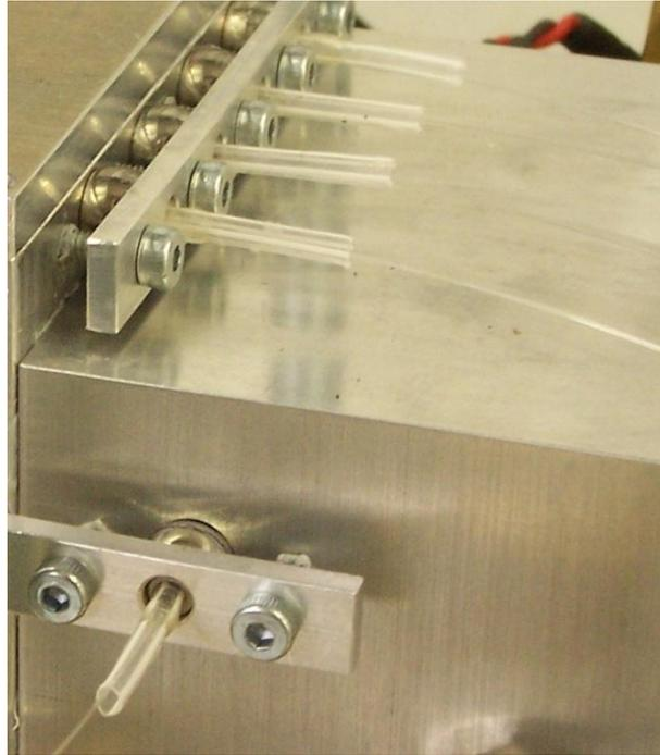
**Abbildung 3.10:** Kugelgelenkhalterung für die GRIN-Linsen-Aufnahme, einem vorne konisch zulaufenden Kunststoffröhrchen. Nach Justierung des Strahl auf den Detektor konnte das Kugelgelenk fixiert werden.
