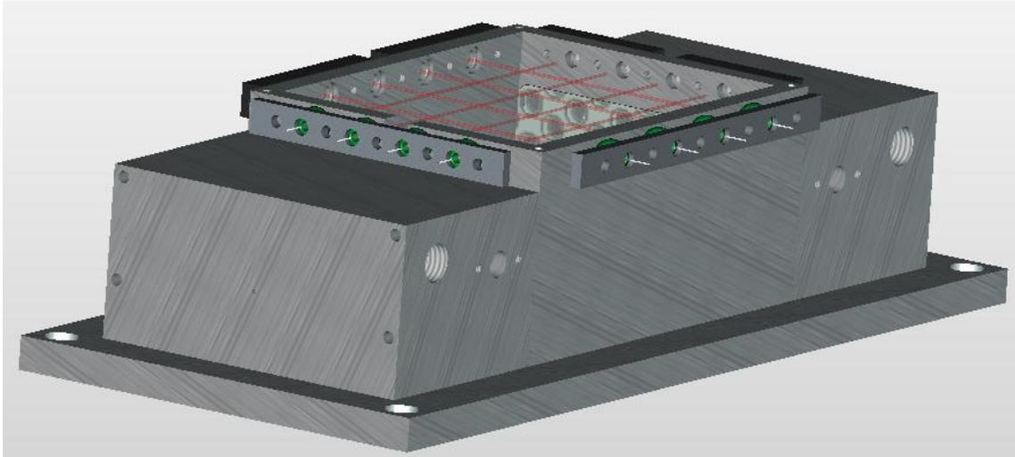
**Abbildung 3.11:** CAD-Visualisierung des Messkammersystems für die flächenaufgelöste Gasmessung parallel zur Blattoberfläche mittels 4 + 4 gekreuzter Lasermesskanäle. Vorgelagert sind Messkammern für die Gaskonzentrationen der eingehenden und ausgehenden Luft. Die Hauptkammer misst 80 x 60 x 40 mm.
