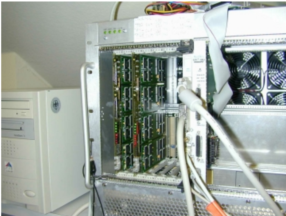
Abbildung 6.11: TRT-Meßaufbau: CompactPCI-System mit zwei parallel betriebenen ACBs
