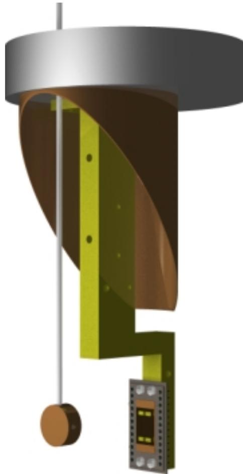
**Bild 4.16:** Blick ins Experimentiervolumen. Am unteren Ende des Probenhalters befindet sich das Oberflächenwellenbauteil, das obere Ende ist am Mischkammerboden befestigt. Abstand und Positionierung der Dusche gewährleisten eine weitgehend gleichmäßige Bedampfung des Substrats.
