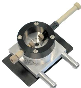
**Abbildung 4.3.2:** Foto der verwendeten *AquaSpec* Messzelle [151]. Die Metallanschlüsse unten rechts sind zur Temperaturstabilisierung der Messzelle, wurden aber in dieser Arbeit nicht verwendet. Oben rechts ist die Zuleitung zu sehen, unten links die Ableitung. Der IR-Strahl geht durch das runde Loch in der Mitte.
