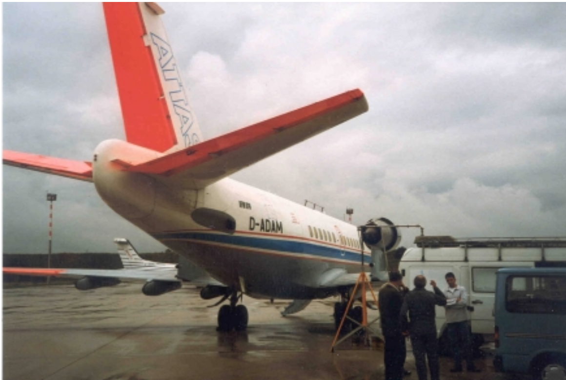
Abbildung 5.1: Fotografie des experimentellen Aufbaus: Kurz hinter der Turbine, der am Boden stehenden ATTAS wurde ein Stativ aufgebaut, welches die Elektrostatische Sonde und das Strömungsrohr mit Einlassöffnung trägt. Im weißen Messbus waren die Massenspektrometer untergebracht.
