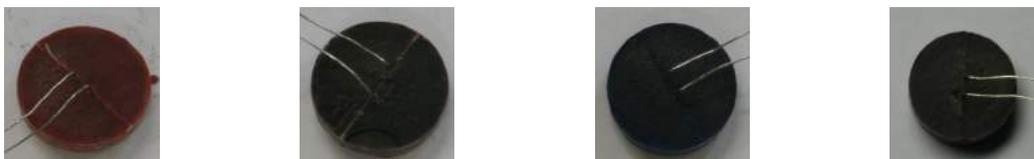
Abbildung 2.12: Im linken Bild ist SF1 auf P25 vor der Messabfolge leicht rötlich zu erkennen mit tiefdunkelbraunen Farbton nach dem Ende, rechts im Anschluss. Die zwei folgenden SF18 auf P25 Vor- und Nachher-Oberflächen sind mit bloßen Auge ununterscheidbar. Charakterisierung mit Reflexionsvermessung im Sichtbaren wäre denkbar.
