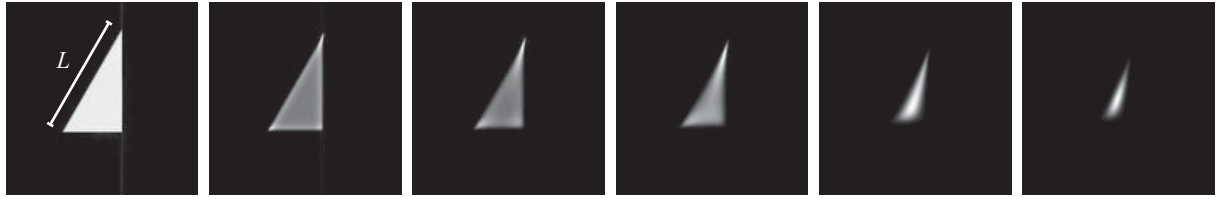
Abbildung 9.16: Randverstärkungseffekt bei Vergrößerung von \delta_2 für (a) zylinderförmige Poren, Poren in Form von (b) gleichseitigen Dreiecken und (c) rechtwinkligen Dreiecken. Links sind wieder Vergleichsbilder der Geometrien gezeigt, welche unter den Idealbedingungen \delta_1 \rightarrow \infty und \delta_2 \rightarrow 0 erhalten werden könnten. Deutlich erkennbar ist die Verkleinerung der Porenbilder für größere Werte von p_{\delta_2} , ebenso wie die Randverstärkung, da die Schwerpunkte der Zufallspfade der Teilchen mit zunehmender Dauer des kurzen Gradienten von den Rändern „weggeschoben“ werden. Für p_{\delta_2} = 0,2 für die dreieckigen Geometrien und für p_{\delta_2} = 0,4 für alle Geometrien ist die Signalanhebung weitgehend in der Porenmitte konzentriert, da sich die Maxima der Randverstärkung verschiedener Seiten überlagern. Simulationsparameter: \delta_1 = 5 \text{ s} , p \approx 100 , D = 2 \mu\text{m}^2/\text{ms} , L = 10 \mu\text{m} ; für (a,b) M = 200 Eigenwerte und für (c) M = 100 Eigenwerte; q_{\text{max}} = 25 \mu\text{m}^{-1} , Auflösung \Delta x = 0,13 \mu\text{m} .
