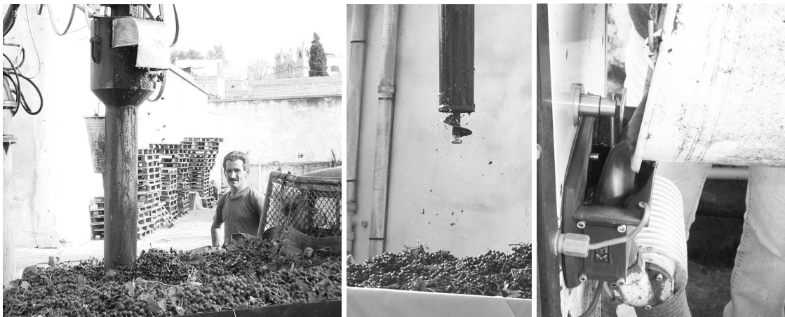
Abb. 7: Ermittlung des Zuckergehaltes mittels preleva campioni (links und Mitte) und mostimetro Babo (rechts) bei der Cooperativa Rossi (Canosa)
