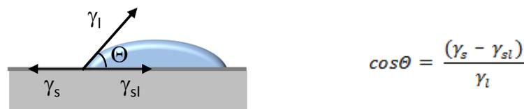
Abbildung 26: Schematische Darstellung eines Tropfens einer nicht vollständig benetzenden Flüssigkeit auf einer festen Oberfläche und der mathematische Zusammenhang der beschreibenden Größen.
