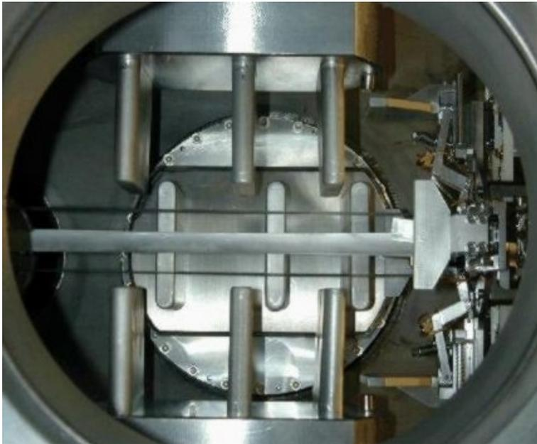
**Abbildung 2-12:** Fotografie der Anordnung von Pot 106, 103 und 109 mit der Hochfrequenzabschirmung. Die Strahlrichtung verläuft von rechts nach links. Die Blickrichtung verläuft entlang  $-y$ . Die Bänder und die T-förmige Druckplatte zur Bewegung der inneren Abschirmung durch den hier entfernten Pot 100 sind deutlich zu erkennen.
