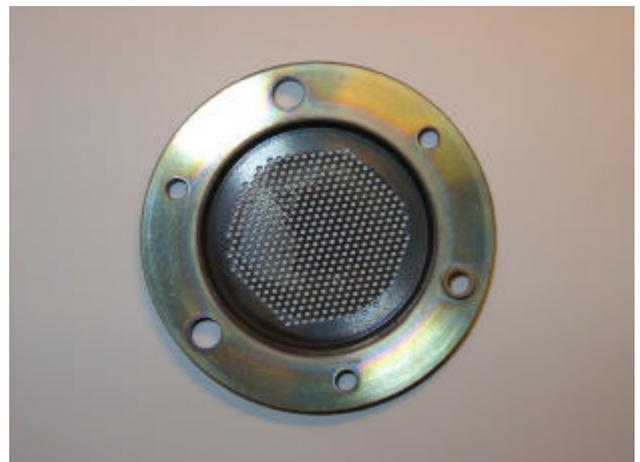
Abb. 6.15 Sputterfolgen am Extraktionssystem der Ionenstrahlquelle MF40
