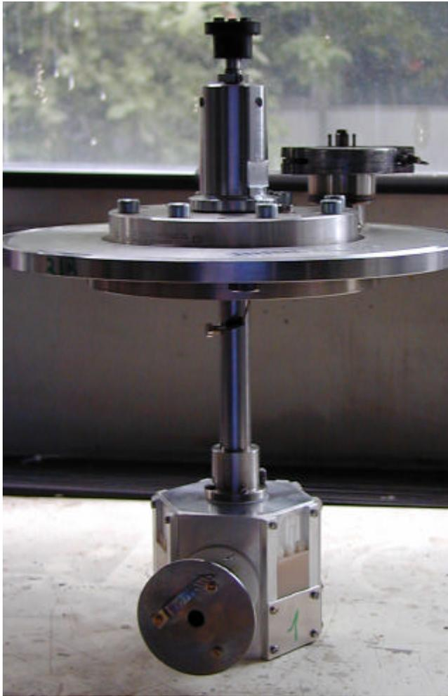
Abb.5.4 Aufbauflansch mit Probenhalterung
