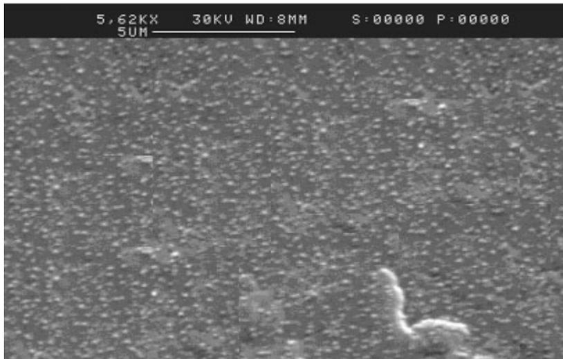
Abb. 7.5 SiO<sub>2</sub>/Platin-Verhältnis 1:1 bei 1.5 keV Ionenenergie
