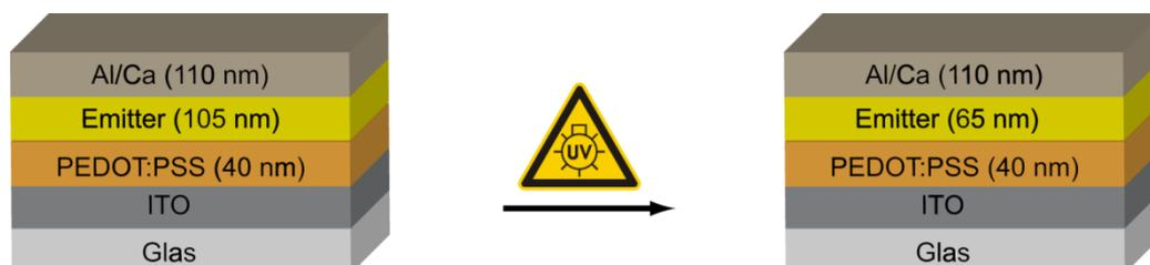
**Abbildung 54.** Schematischer Aufbau der OLED mit dem Copolymer *poly-36-alt-27a* als Emitterschicht (Gelbemitter) vor und nach der UV-Exposition (**Hinweis:** die OLEDs wurden ohne Kathode bestrahlt). Ergebnisse von SERPIL TEKOGU, *laufende Dissertation*, KIT.
