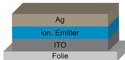
**Abbildung 61.** Schematischer Aufbau der PLEC.
