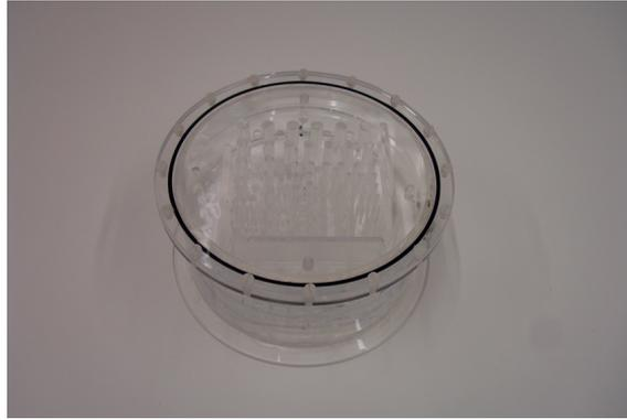
**Abbildung 3.2:** Auflösungsphantom für die  $^{23}\text{Na}$ -MRT. Das Plexiglasgefäß ist mit einer 80 mmol/l NaCl-Lösung befüllt.
