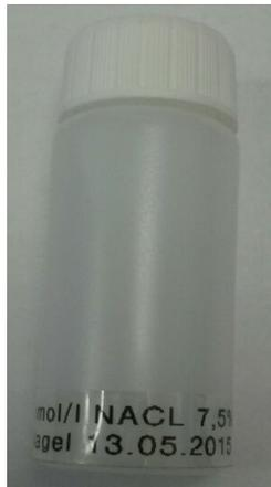
Abbildung 3.3: Als Phantom verwendete Probenflasche mit NaCl-Lösung und 7,5% Agarose
