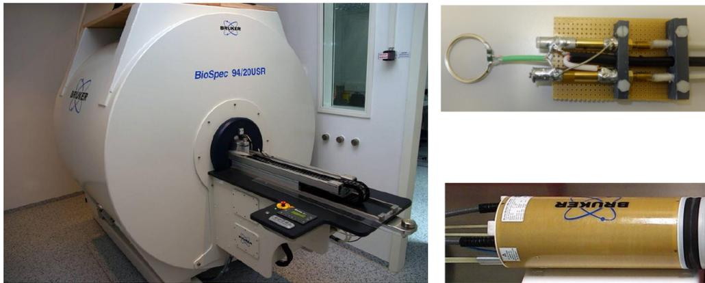
Abbildung 3.1: Links: 9,4 T Kleintierscanner mit automatischem Positionierungssystem. Abbildung aus [Kal13]. Rechts oben.  $^{23}\text{Na}$ -Single-Loop-Oberflächenspule für den Bioreaktor. Rechts unten:  $^1\text{H}/^{23}\text{Na}$  Volumenspule. Abbildung aus [Kal13]
