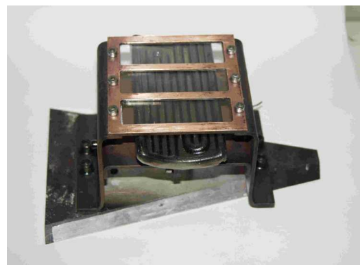
Abb. 64: Halter (Typ II) mit verschraubter Kupfermaske
