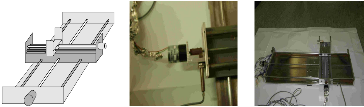
Abb. 60: schematischer Aufbau, Schlittenantrieb und Komplettsystem
