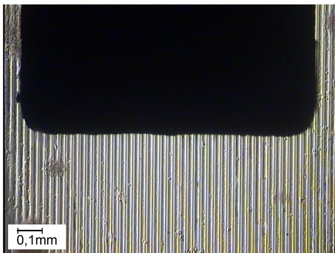
**Abbildung 4.9:** Größenübersicht der PDMS-Linien neben einer Elektrode bei 10-facher Vergrößerung: Der schwarze Bereich am oberen Bildrand zeigt die Elektrode. Die Linienstruktur parallel zu den Seiten der Elektrode ist die PDMS-Strukturierung.
