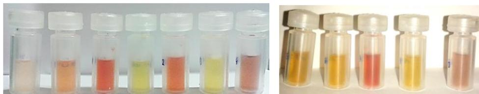
**Abbildung 74.** Optischer Vergleich der Reaktionslösungen der Reaktion zwischen OPA und Phenylalanin in unterschiedlichen Verhältnissen der Reaktanden, links in LiOH-Puffer, rechts in Borat-Puffer (Verhältnisse in LiOH OPA/Phe: 1:1, 2:1, 1:2, 3:1, 1:3, 4.5:1, 1:4.5; Verhältnisse in Borat OPA/Phe: 1:1, 2:1, 1:2, 4.5:1, 1:4.5).
