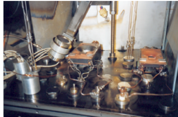
Abbildung 3.3: Elektronenstrahlverdampfer (vgl. Abbildung 3.1: 1A: ESV14, 1B: ESV6) und Ionenquelle (links).
