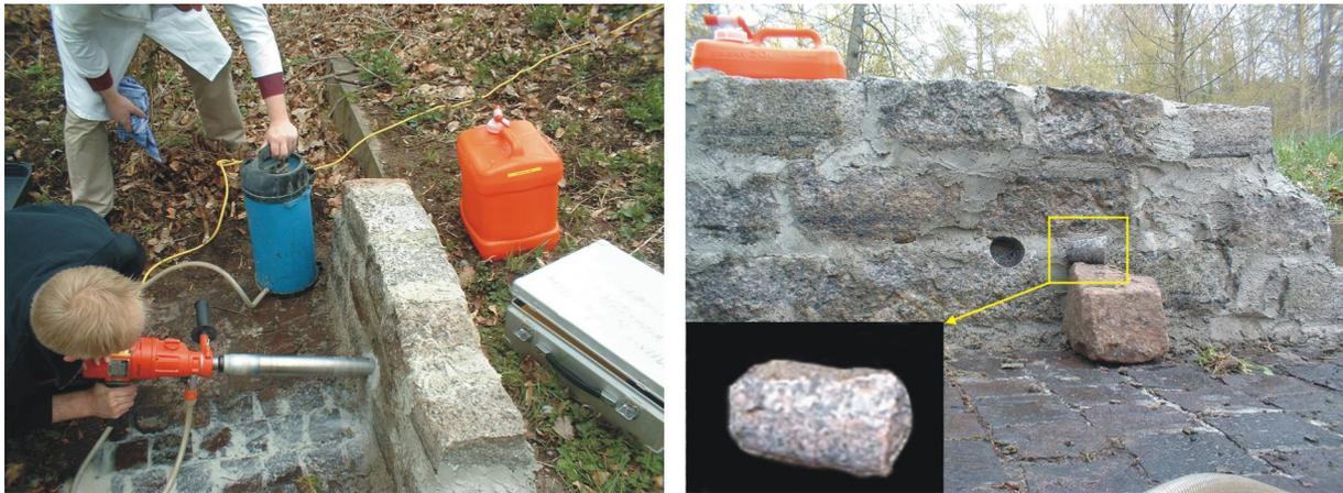
Abbildung 4.5: Links Entnahme eines Querböhrkerns mit ca. 55 mm Durchmesser (rechts).
