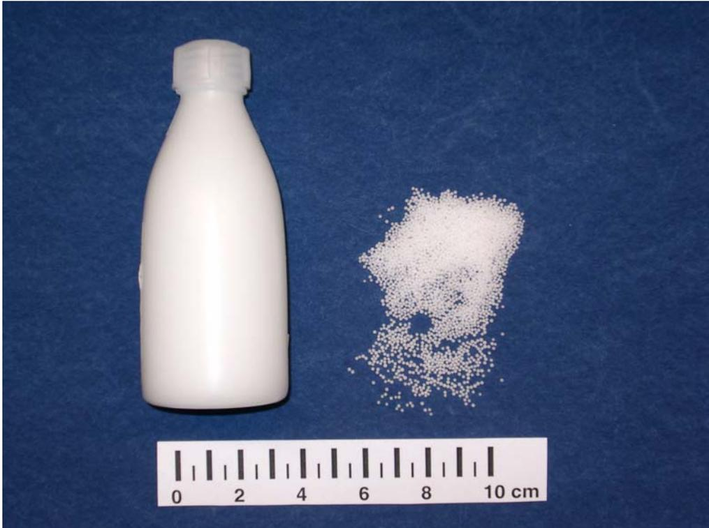
Abb. 3.7: Porenphantom A. Rechts: Kugelförmiges PVC-Granulat, mit dem die Flasche gefüllt wurde.
