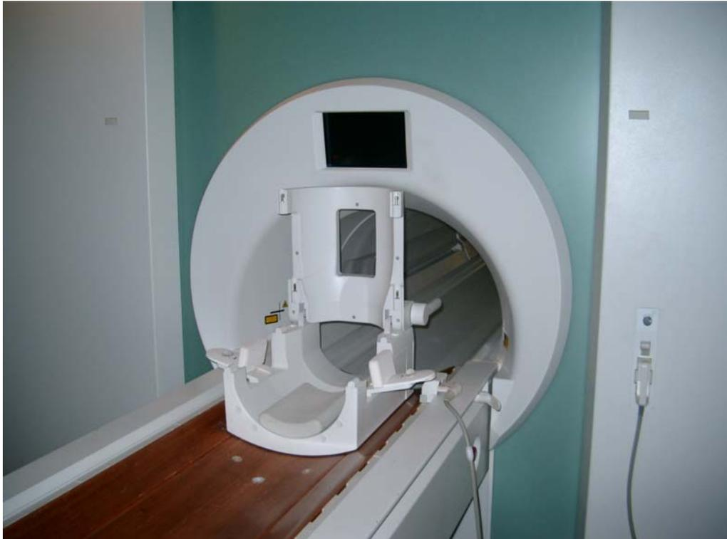
Abb. 3.2: Zirkularpolarisierte Kopfspule vor der Röhre des Tomographen.
