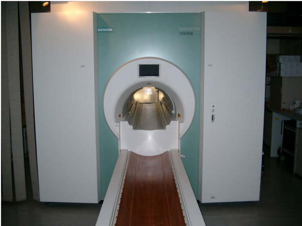
Abb. 3.1: Frontansicht des 1,5-Tesla-Ganzkörper-Tomographen des Typs Magnetom Vision<sup>®</sup>.
