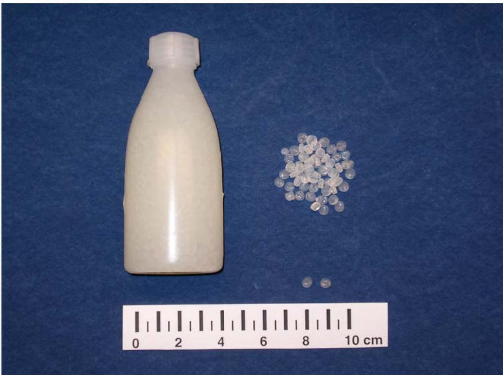
Abb. 3.8: Porenphantom B. Rechts: Zylinderförmiges PVC-Granulat, mit dem die Flasche gefüllt wurde.
