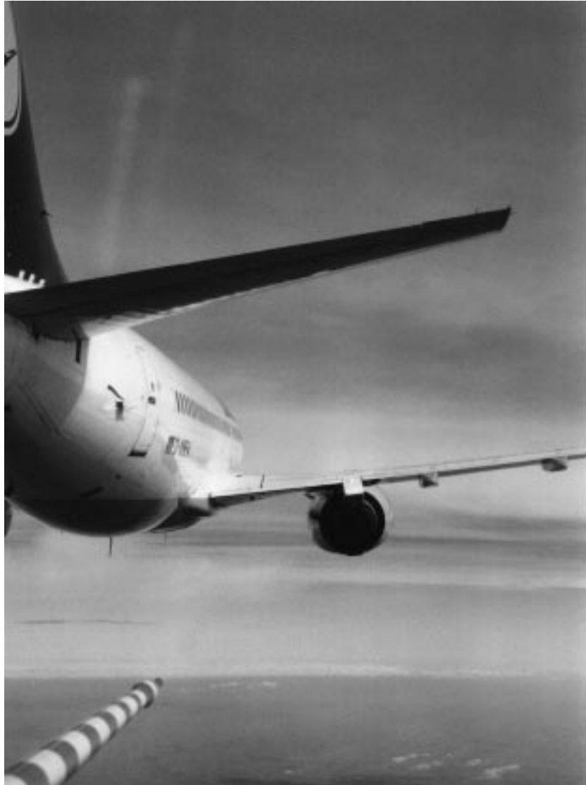
Abbildung 6.1: B-737 vom Falcon-Cockpit aus gesehen. Der Abstand beträgt etwa 25 m, als rot-weißer Stab ragt der auf der Nase der Falcon montierte Turbulenzsensor ins Bild.
