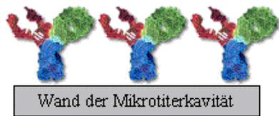
(1) Beschichtung der Mikrotiterplatte mit dem Antikörper (**Coating**)
