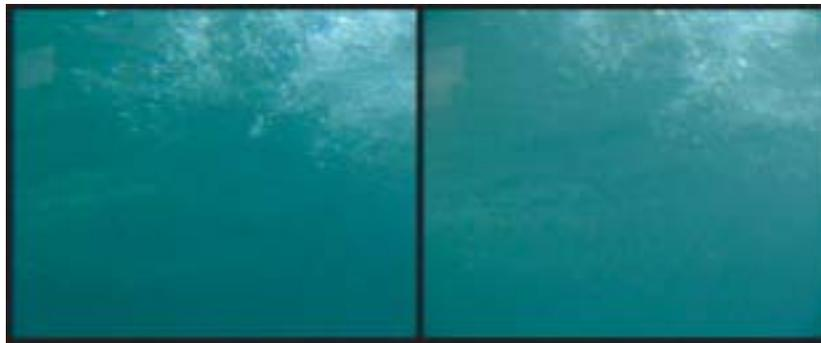
Abbildung 2.2: Ansichten einer sich brechenden Welle von schräg unten im linearen Wind-Wellen-Kanal in Deft. Der 100 m lange Kanal hat eine Breite von 8 m bei einer Wassertiefe von 80 cm. Man kann die Luftblasen, die von der brechenden Welle in den Wasserkörper eingetragen werden, deutlich erkennen. Diese Blasen tragen auch zum Gasaustausch bei. Quelle: [JÄHNE 2001].
