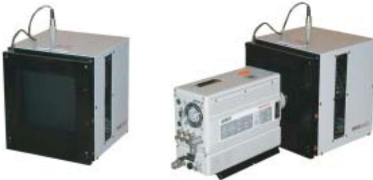
Abbildung 4.7: Der zur Temperaturkalibrierung verwendete Blackbody 2006G mit (rechts) und ohne die Infrarotkamera Amber Radiance (links).
