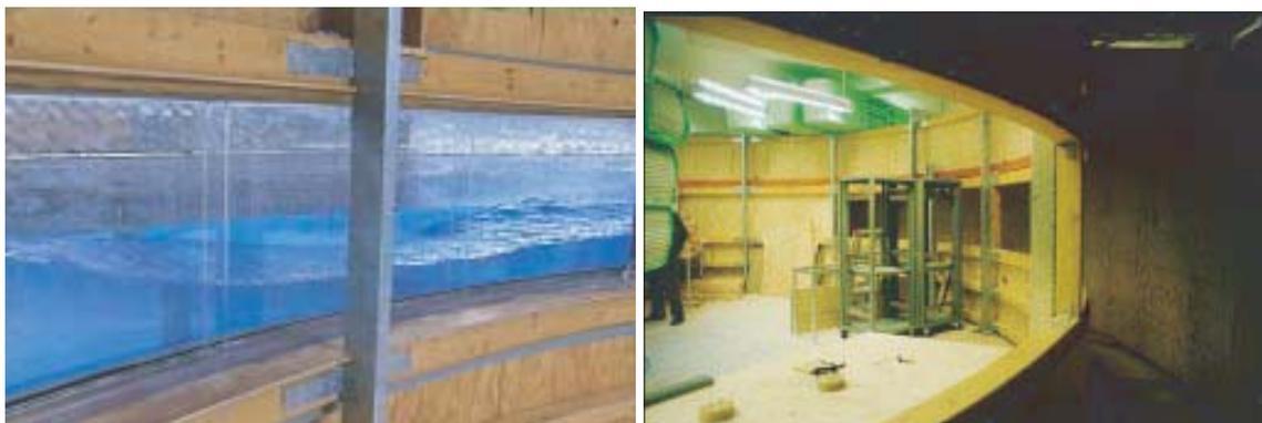
Abbildung 1.3: Das ringförmige Heidelberger AEOLOTRON (Durchmesser: 10 m) im Betrieb und während der Bauphase im Mai 1999. Die Wasserrinne mit einer Breite von 60 cm ist mit einer 9 cm dicken Styrodurschicht isoliert um den Wärmeverlust im Kanal so gering wie möglich zu halten. Quelle: [JÄHNE et al. 1999].
