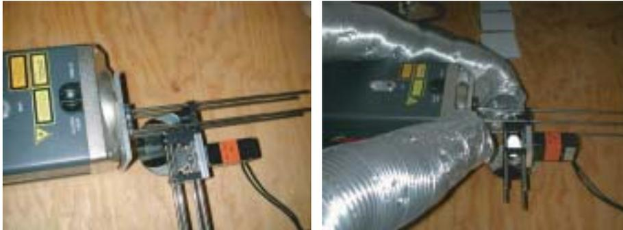
Abbildung 4.10: Laser und Scanneroptik mit und ohne Luftkühlung
