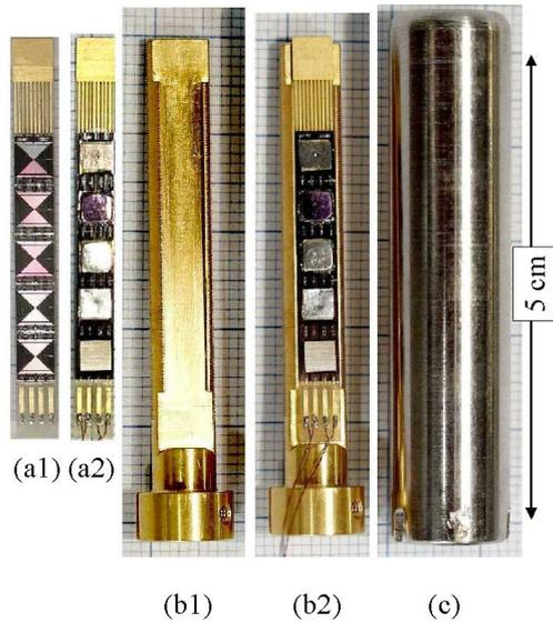
**Abb. 2.9:** Fotografien der einzelnen Teile, aus denen das Fixpunktthermometer SRD1000 besteht. (a1) Planare Induktivität, (a2) Supraleitende Metalle auf den Detektorspulen, (b1) Träger aus mit Gold beschichtetem Kupfer, (b2) Träger mit den montierten Detektorspulen, (c) Abschirmung aus Cryoperm. Mit freundlicher Genehmigung von W. Bosch, HDL.
