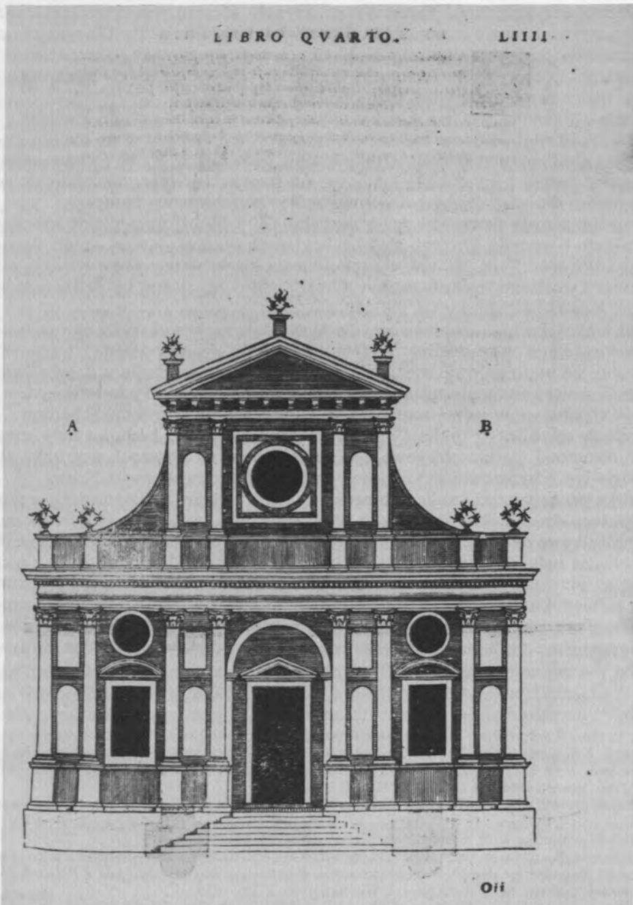
36. Sebastiano Serlio, wzorcowy projekt fasady kościoła bazylikowego. Wg S. Serlio, Regole generali di architettura , k. 54.
