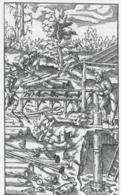
Abb. 3 Herstellung und Gebrauch einer handbetriebenen Saug- bzw. Druckpumpe zur Stollenentwässerung (nach Agricola: De re metallica, 1556, VI)
