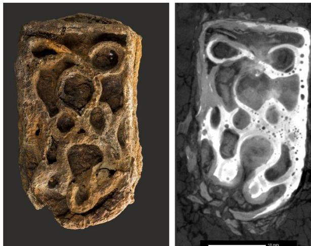
**Abb. 6.8:** Photographie des Eisenbeschlags aus Grab 1131 (links, Abb. Y. Mühleis) und frontales  $\mu$ -RCT-Schnittbild des Beschlags (rechts) auf der Ebene des Lotes, das sich heller und mit Gaseinschlüssen zwischen der Grundplatte und den Stegen der Filigranverzierung darstellt.
