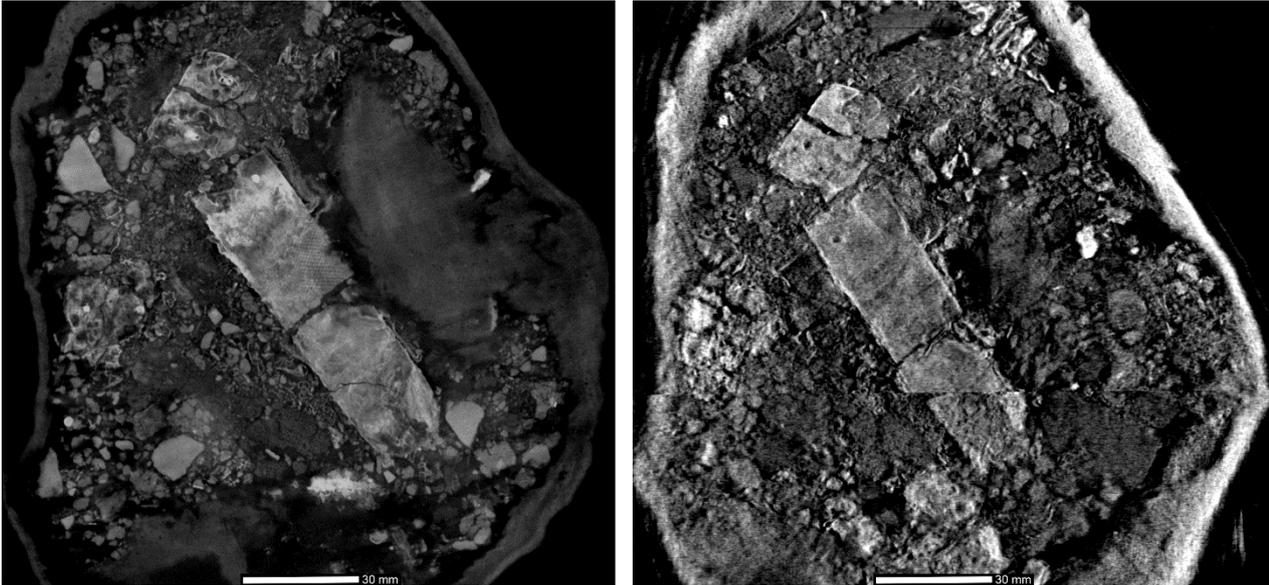
**Abb. 3.6:** Frontale Schnittbilder der Blockbergung aus Grab 100 der CT mit Röntgenstrahlung (links) und Neutronen (rechts).
