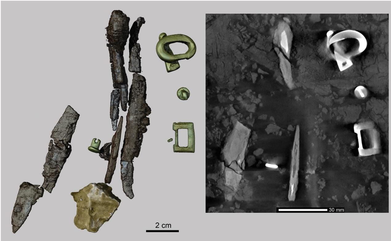
**Abb. 6.16:** Dreidimensionale  $\mu$ -RCT-Darstellung der fragmentierten Eisengeräte, des Silex und der zwei Schnallen und zwei Gürtelhaften aus hochlegierter Zinnbronze aus Grab 1268 in Fundlage. Das frontale  $\mu$ -RCT-Schnittbild (rechts) zeigt den Ausschnitt der Blockbergung, in dem sich die Schnallen und Gürtelhaften befinden.
