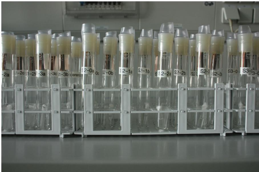
Abbildung 3.5: Ausschnitt einer Testserie zur Prüfung mit dem Oddy Test vor der Wärmealterung im Klimaschrank.
