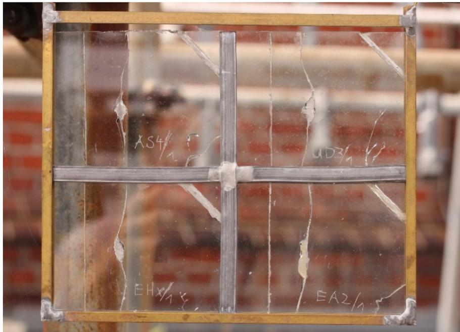
Abbildung 3.6: Musterfenster, bestehend aus vier Einzelscheiben, mit jeweils vier verschiedenen Sprungbildern, die Scheiben wurden mit verschiedenen Klebstoffen gefügt.
