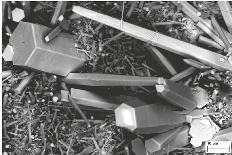
**Abb. 4.31:** FE-REM BSE Aufnahme von  $\text{NaPb}_2(\text{CO}_3)_2(\text{OH})$ -Kristallen
