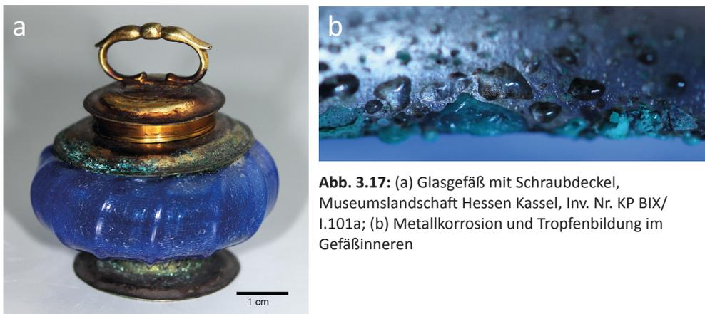
**Abb. 3.17:** (a) Glasgefäß mit Schraubdeckel, Museumslandschaft Hessen Kassel, Inv. Nr. KP BIX/I.101a; (b) Metallkorrosion und Tropfenbildung im Gefäßinneren
