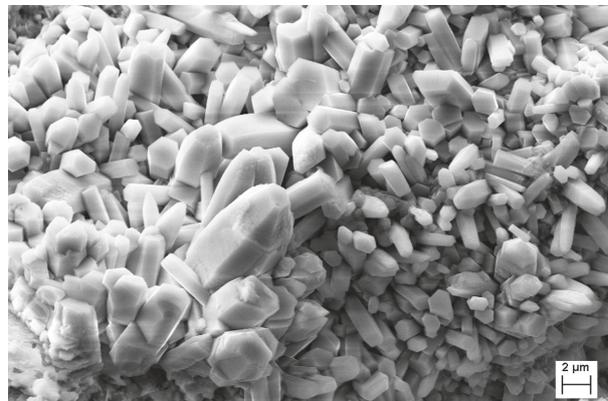
**Abb. 4.34:** FE-REM SE Aufnahme der Probe vPST-ohne-1-11: hexagonal, nadelförmige Kristalle
