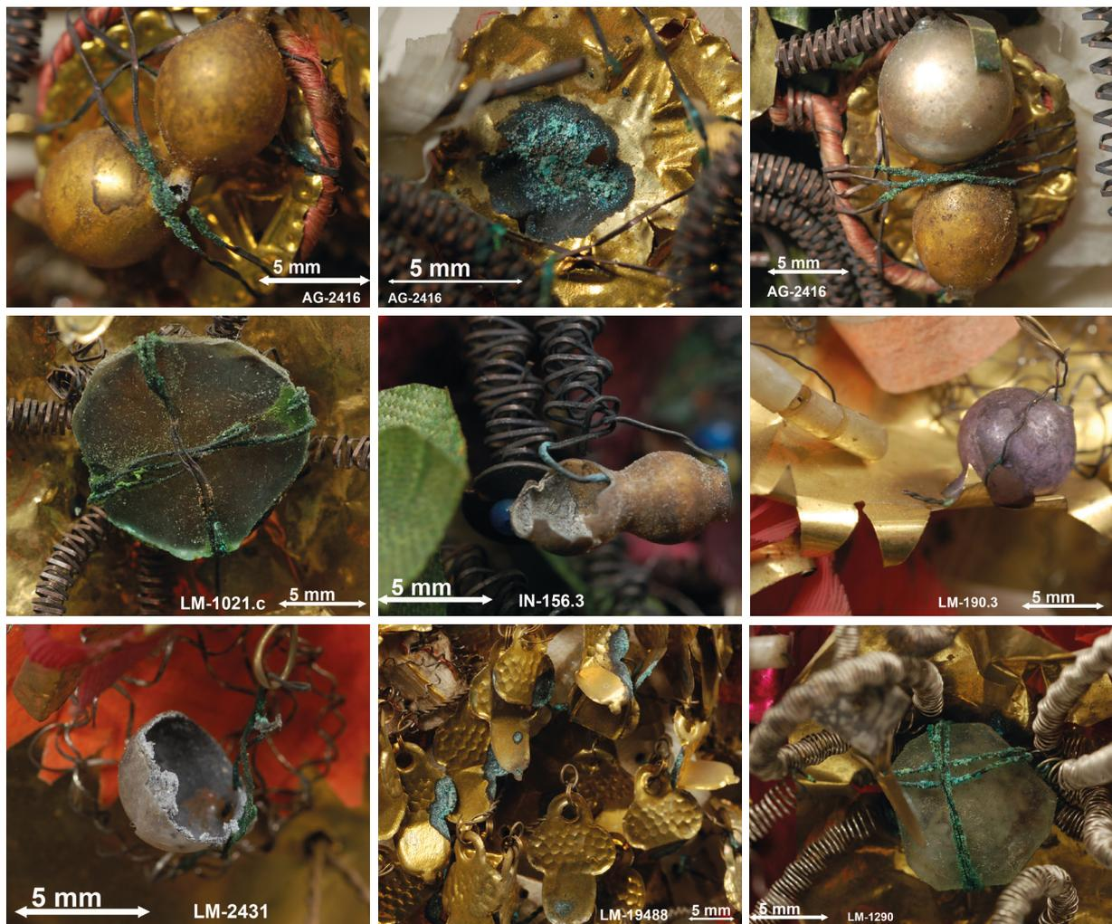
**Abb. 3.20:** Detailaufnahmen von Schadensbildern an Brautkronen aus dem Schweizerischen Nationalmuseum. Regelmäßig wurden korrodierte Drähte aus Kupferlegierungen, Messingfolien oder Bleiverspiegelungen in Kontakt zu Perlen oder Glasfragmenten beobachtet.
