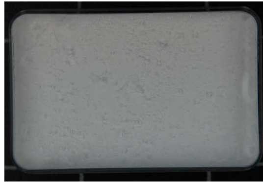
Abbildung 58: Lösung aus 10% Mannitol nach der Gefriertrocknung.
