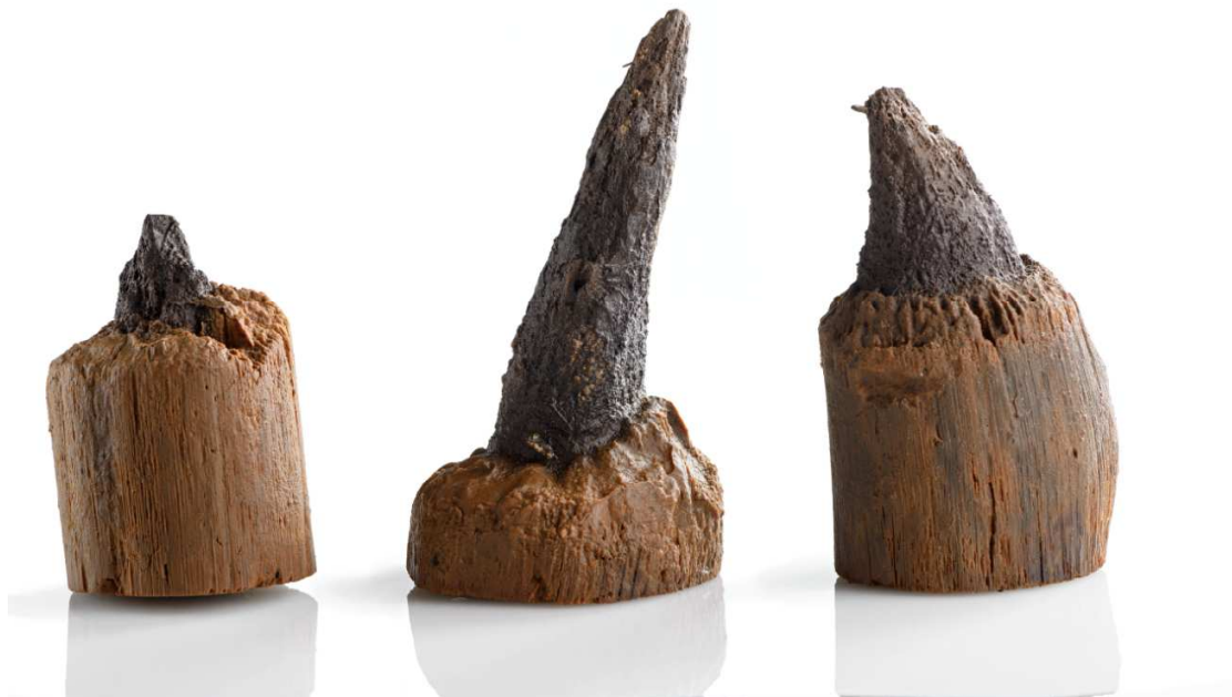
Abbildung 8: Für eine dendrochronologische Untersuchung wurden Pfähle aus Sipplingen, Bodenseekreis, beprobt. Die aus dem Sediment ragenden, stark abgebauten äußeren Bereiche der Pfähle zeigen starke Erosion. Das weniger stark abgebaute Kernholz hat einen höheren mechanischen Widerstand. Foto: Landesdenkmalamt für Denkmalpflege im RP Stuttgart (Y. Mühleis).
