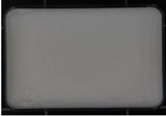
Abbildung 49: Lösung aus 20% PEG 2000 nach der Gefriertrocknung.
