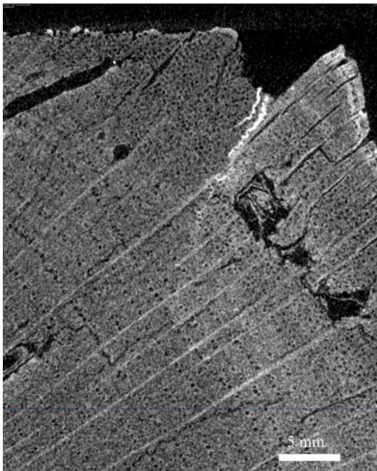
Abbildung 107: CT Schnittbild von Probe #2.3; Konservierung mit 20% PEG 4000, Gefriertrocknung. Landesdenkmalamt für Denkmalpflege im RP Stuttgart (J. Stelzner)
