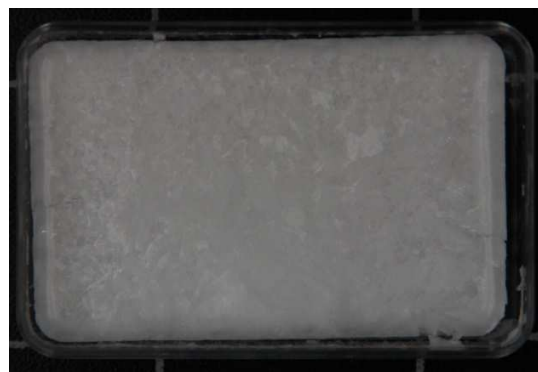
Abbildung 54: Lösung aus 20% Trehalose nach der Gefriertrocknung.
