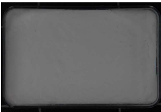
Abbildung 53: Lösung aus 20% PEG 4000 + 20% PEG 400 nach der Gefriertrocknung.
