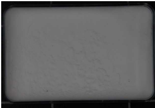
Abbildung 51: Lösung aus 20% PEG 4000 + 5% PEG 400 nach der Gefriertrocknung.
