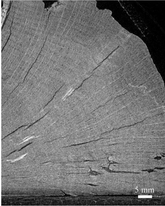
Abbildung 109: CT Schnittbild von Probe #4.1; Konservierung mit PEG 4000, 20%; PEG 400, 10%, Gefriertrocknung. Landesdenkmalamt für Denkmalpflege im RP Stuttgart (J. Stelzner)
