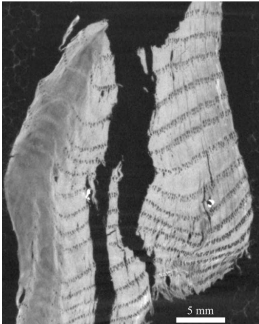
Abbildung 105: CT Schnittbild von Probe #0.1 ohne Konservierung, Lufttrocknung. Landesdenkmalamt für Denkmalpflege im RP Stuttgart (J. Stelzner)
