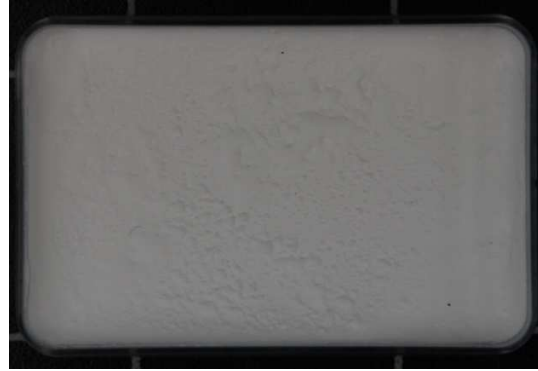
Abbildung 50: Lösung aus 20% PEG 4000 nach der Gefriertrocknung.
