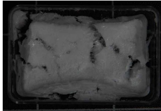
Abbildung 56: Lösung aus 20% Lactitol nach der Gefriertrocknung.
