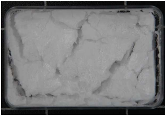
Abbildung 57: Lösung aus 20% Saccharose nach der Gefriertrocknung.
