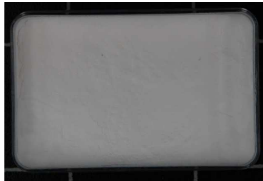
Abbildung 52: Lösung aus 20% PEG 4000 + 10% PEG 400 nach der Gefriertrocknung.
