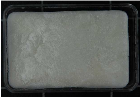
Abbildung 55: Lösung aus 20% Luviskol K30 nach der Gefriertrocknung.
