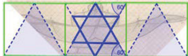
Abb. 67r, Rekonstruktion: weitere Ergänzung um gleichseitige Dreiecke, Winkel und Maße (blau); zwei gleichseitige Dreiecke (blau) im mittleren Rechteck (grün) bestimmen Höhen und Breiten von Fuß, Nodus und Spirale
