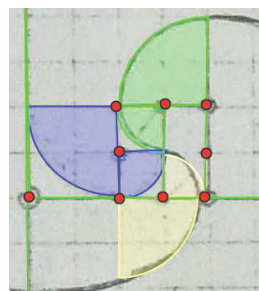
Abb. 192c, Rekonstruktion: Hervorhebung spiralförmiger Viertelkreissegmente (gelb, grün, blau); je 3 Viertelkreisbögen mit r=1 und 2
