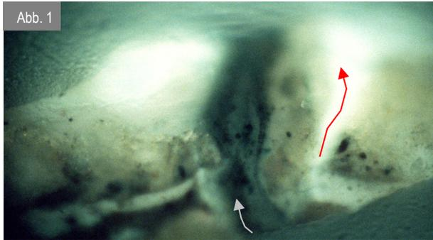
Abb. 1: In einer 2. Schliiffebene, zeigt die pfeilartige Form (↑) deutlich an, dass sich Schwarz nach oben gedrückt hat, auch Zwischenfirnis bildet einen eigenen Pluton (↑).
