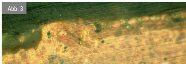
Abb. 3: Pos. 1b, Probe im Querschliff B18.1 (VIS) kann eine gestörte Schichtung andeuten. Unter UV-Strahlung unterscheiden sich die Lagen deutlicher (Abb. 4):
