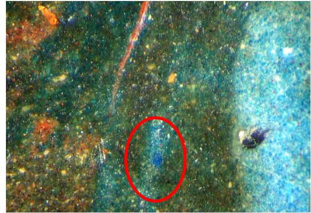
Abb. 3.2.5 / 21 (B_III/1_40a) Abb. 3.2.5 / 22 (B_III/1_40b) Nach mikroskopischem Befund dürfte der dunkelblaue Farbauftrag ein Lapislazuli-Pigment sein – nicht das feinteiligere Berliner Blau. Dieses ist z.B. in der hellblauen Farbschicht am rechten Abbildungsrand von / 21 verwendet worden. Eine Ausmischung mit schwarzem Pigment ist mikroskopisch zu erkennen. / 22: In der roten Markierung: gröberes Lapislazuli-Pigment; unterschiedliche Ausmischung mit Weiß/Schwarz
