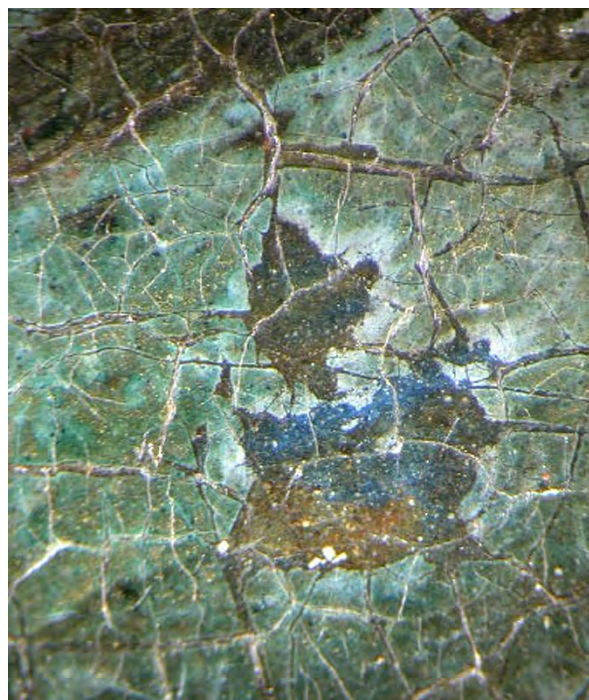
Abb. 3.1.6 / 6 (B_IV_11) Bildbeispiel zu Proben 1, 2 und 3: Berliner Blau + Bleiweiß über Lapislazuli (liegt im Ausbruch)
