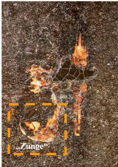
Abb. 4.2.1 / 3 (B_II_15b) Nach vorne gedrückte Grundierung im Bereich der durchbrochenen Dübellochwand. Materialabtrag an der unteren Kante der ‚Zunge‘
