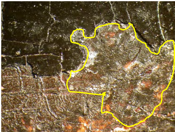
Abb. 3.2.6 / 28 (B_VI_07) Wachsartiges Material auf MS von Phase 2
