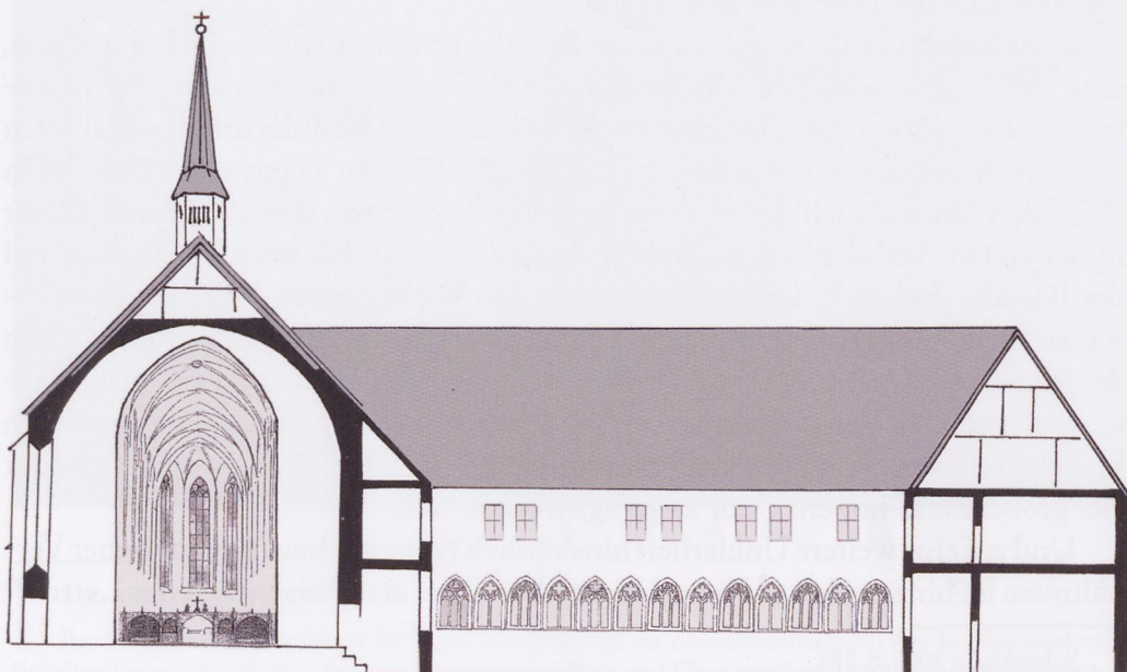
Abb. 27 Rekonstruktionsvorschlag der ehemaligen Saalkirche mit Holztonne über dem Langhaus; Zeichnung: Günther Haberhauer
