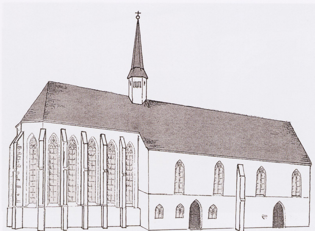
Abb. 17 Rekonstruktion mit Strebpfeilern; Zeichnung: Günther Haberhauer
