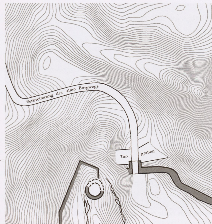
Abb. 10 Wildenstein – Hypothese zu einer Erstplanung von Burgweg, Torgraben und Tor, die wegen der zu großen Steilheit des Weges abgebrochen und durch den Felsentunnel ersetzt wurde. Zeichnung Thomas Biller.
