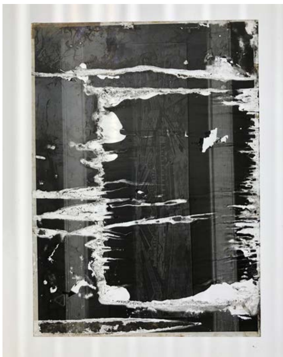
Abb. 2 Glasplattennegativ mit aufgelöster und zerflossener Emulsionsschicht.
