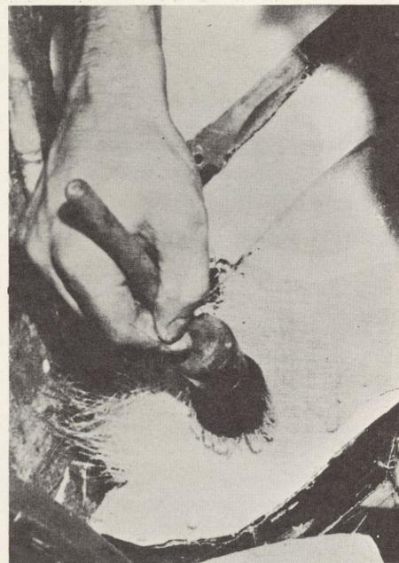
Nach Anhängen der Feinschicht werden Glasmatten einlaminiert.
