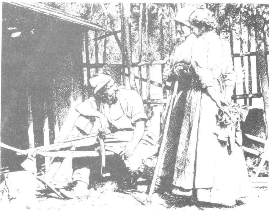
*Die Schnitzbank und das Schnitzmesser waren Universalgeräte. Eine fußbediente Klemmvorrichtung hielt das Holzstück fest, aus dem man einen Stiel für ein landwirtschaftliches Gerät oder "Stickscheite" für den Hausbau schnitzen und auch einen Bohnenstecken entrinden konnte.*
