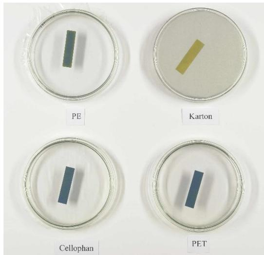
**Abb. 79:** Verfärbung der auf die unterschiedlichen Barrierematerialien über Essigsäure gelegten AD-Strips nach 2 min
