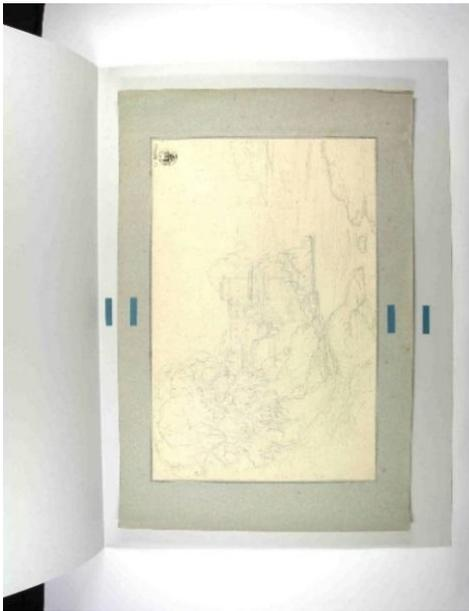
**Abb. 86:** Versuchsaufbau: Positionierung der AD-Strips in den Umschlägen.
