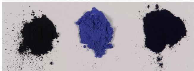
**Abb. 19:** Blaupigmente, die im 19. Jahrhundert zur Färbung von Papier eingesetzt wurden (von links nach rechts): Indigo, Smalte und Preußisch Blau.
