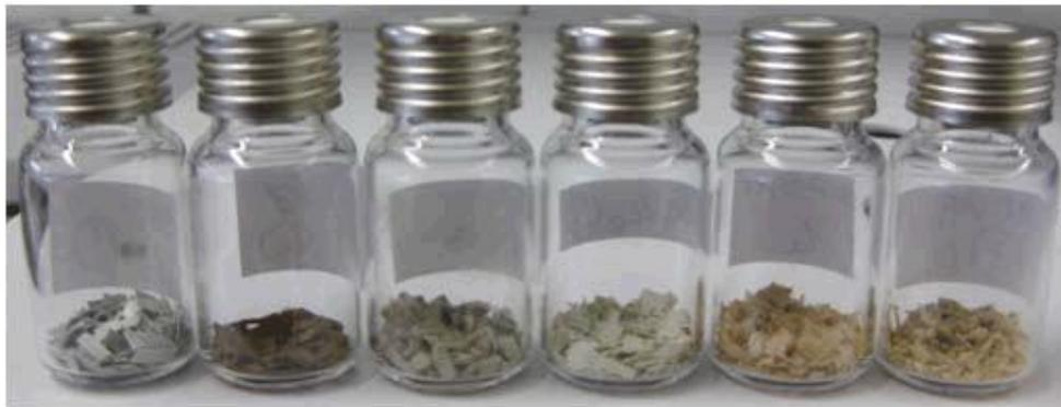
**Abb. 46:** Die Testmaterialien werden in Glasgefäßen gasdicht verschlossen. Nach Erhitzung werden Luftproben durch das Septum im Deckel entnommen und per GC/MS ausgewertet (Quelle: Universität für Bodenkultur).
