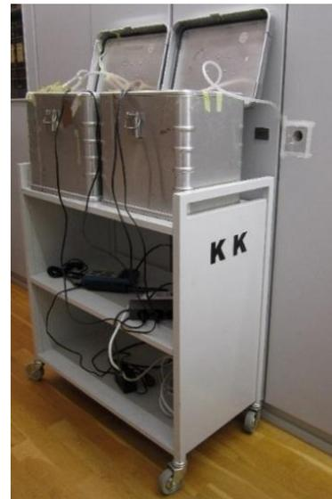
**Abb. 41:** Luftprobenahme aus dem Aufbewahrungsschrank
